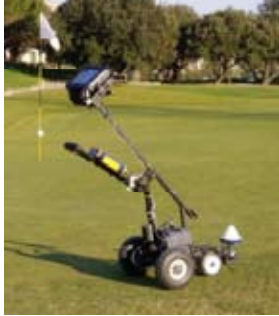
Le système de mise à jour de relevé topographique de surface sur chariot motorisé et autoalimenté
